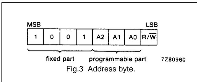
Fig.3 Address byte.
