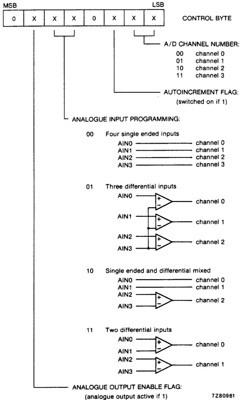
Fig.4 Control byte.
